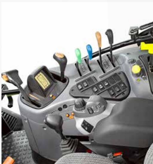
Le Profi Classic est équipé de distributeurs auxiliaires mécaniques et du relevage électronique (EHR).
