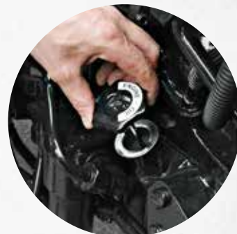
Vérification du niveau d'huile et recharge d'huile sans soulever le capot du moteur.
