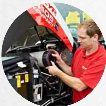
Un nettoyage continu au moyen d'un filtre Piclon garantit que le filtre n'a besoin d'être entretenu que si le voyant correspondant s'allume.
