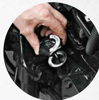
Contrôle du niveau d'huile et appoint en huile sans soulever le capot moteur.
