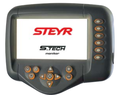
Moniteur STEYR S-TECH. Ce moniteur affiche les fonctions et permet de contrôler tous les outils compatibles ISOBUS.
